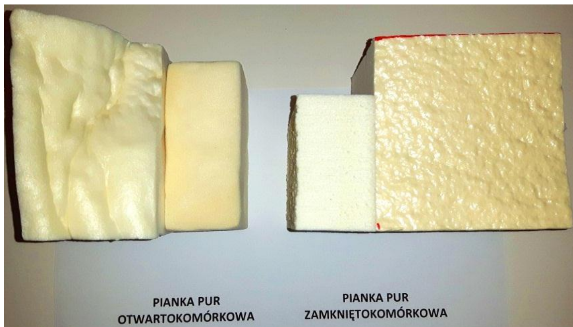
Rys. 1. Fotografia przedstawiająca próbki różnych rodzajów pianek PUR (źródło: fotografia własna)
