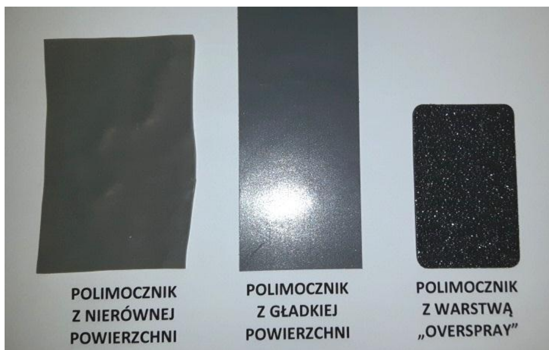
Rys. 2. Fotografia przedstawiająca różne próbki polimocznika (źródło: fotografia własna)
