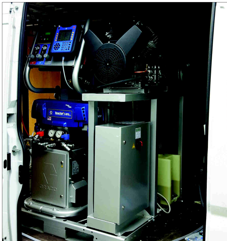
Fot. 6. Agregat do aplikacji izolacji natryskowych
