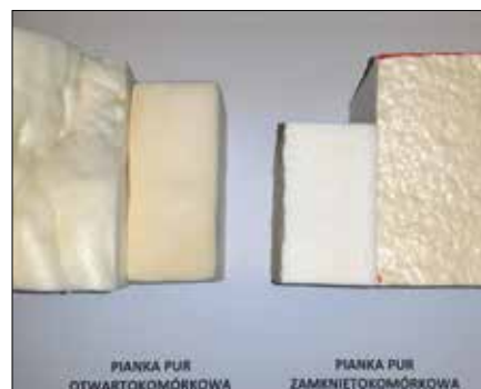
Fot. 8. Próbkę dwóch rodzajów piany PUR (archiwum firmy Compact-Project)
